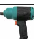
Гайковерт пневматический композитный 1 1/2"DR, 7500 об./мин. 930 Нм JAI-0964
