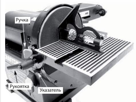
Рис. 5 Використовування столу з кругом
