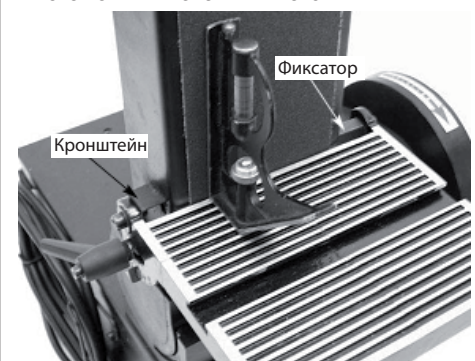
Рис. 6 Використовування столу зі стрічковим вузлом
